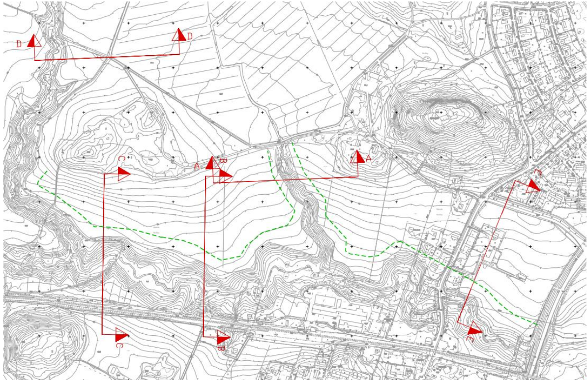
Kuva 4 Stabiiliteettilaskelmien perusteella tehty rajausta turvallisen rakentamisen alueesta. Vihreän katkoviivan ja puroomien väliin ei suositella esitettäväksi rakentamista.
