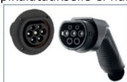
Type 2. Normaalilataus, vaihtovirta, pakollinen normaali- latauspisteellä
