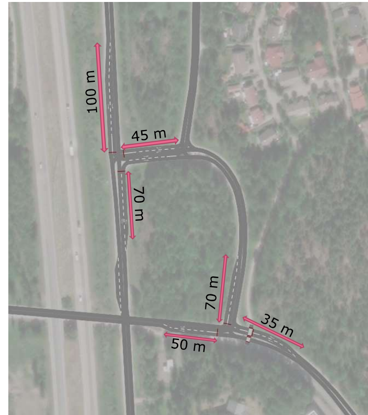
Simulointimalliin rakennetut kääntymiskaistat
